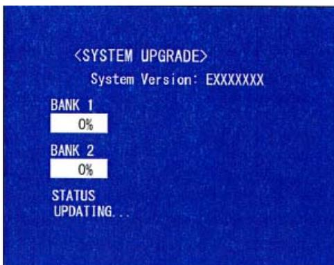
6. Nach etwa einer weiteren Minute wird bei „BANK 1“ und „BANK 2“ 100% erreicht und „UPGRADE COMPLETE“ erscheint wie im folgenden Bild:
